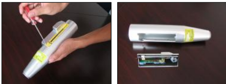
图 5.6 拆卸采样器并与传感器壳体分离
