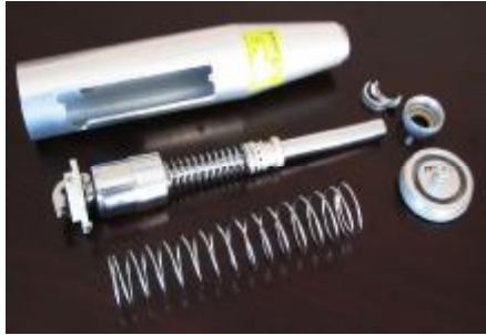
图 5.5 拆卸出机械机芯
